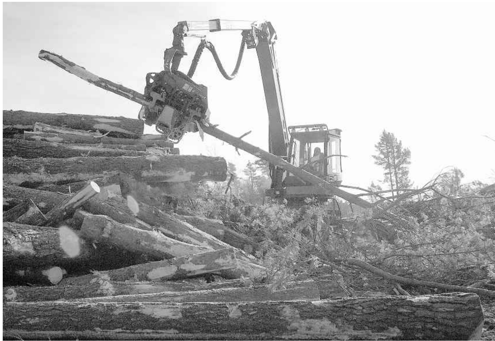
Mit dem Harvester werden die gefällten Bäume geschält, auf Länge zugeschnitten und sortiert: Stämme gehen in die Holz- und Spanplatten-Industrie, Äste und Schlagabraum werden für das Simmerarther Holzkraftwerk gehäckselt.
